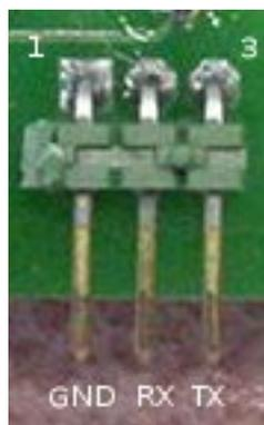
FIG. 4.4 – Brochage des connecteurs des ports USART0 et USART1
